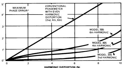
COMPARISON OF ERRORS DUE TO EVEN HARMONIC DISTORTION
